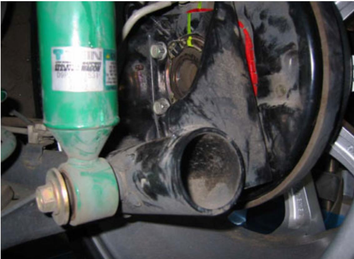
フロントには EZ カムを取り付けてキャンバーを調整、最後にフロントトーを調整して作業を終了します。
