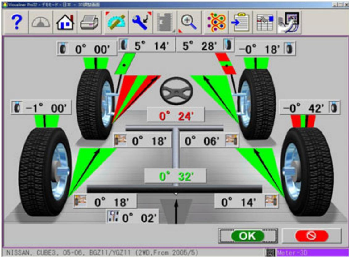
リア測定結果の詳細 SPC パーツ EZ シムを取り付け基準値に近づけます。
