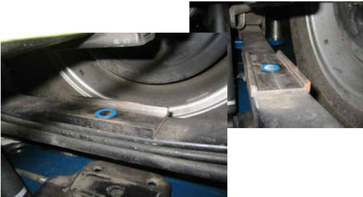
プラスチックスペーサープレートの両面に潤滑油を塗ります。この白いプラスチックプレートは、アクスル(ホーシング)を調整させるときに、スライドしやすくするためのもので、位置が決まったら後で抜きます。丸い穴は抜き取り時のハンドルで、抜きやすい方に向けておきます。
