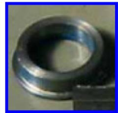
ボトムプレートを置いてみると、リーフスプリングセンタリングピンが少し高いため、ボトムプレートと高さが合うように削る必要がありました。写真は、削られて高さを合わせた状態です。
