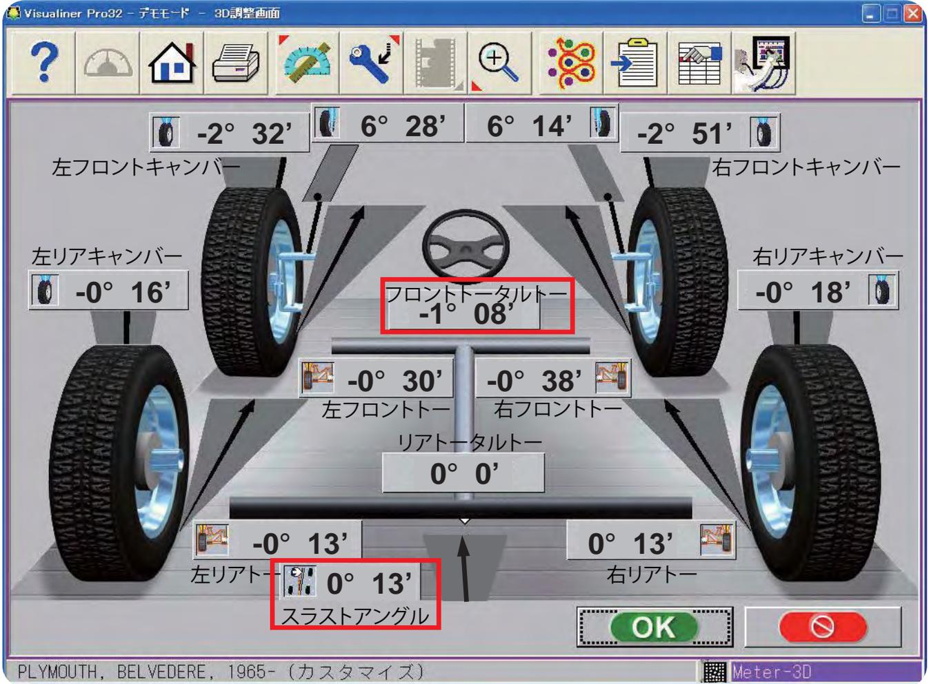
この車両のホイールアライメントデータを入手できず許容範囲を入力していないため、すべてグレーで表示されています。
