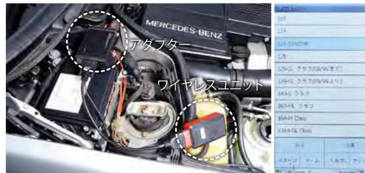
W124型メルセデスベンツ(AMG E60)は、エンジンルーム右側にECUがあり、キャップを外してアダプターを接続。赤い部分がX-431 Diagunのスマートボックス(Bluetooth内蔵)。X-431 Diagunはカラー液晶で見やすく、ワイヤレスなので、コードの取り回しに気を遣うこともないので快適。
