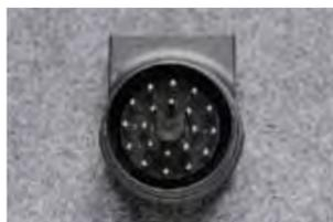
国産車や輸入車の旧診断コネクタ用のアダプター形状。これらを採用する車種はコネクタがエンジンルームに配置されている場合もあるので、診断時にオートデータなどのサービス資料で確認したい。
