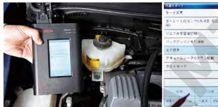
パーソナルユースでも求めやすいコードリーダーでありながら、作業サポート機能を搭載しているISO D。これは、プリウスのブレーキエア抜き作業のメニューだが、この他にも車種によってはサービスマインダーのリセット機能などがある。またISO Dのスクリーンショット機能を使ってTFカードへ保存することにより、パソコンへ転送して閲覧したり顧客管理用ファイルとして活用することもできる。
