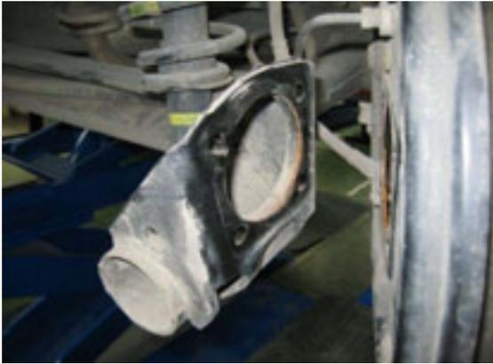
ボディージャッキアップポイントで車両後部を上げ、タイヤを外し、4本の取り付けボルトとABSセンサーを外します。ブレーキラインを傷めないように注意します。
