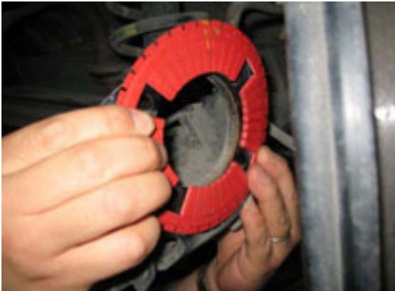
EZシム接触面を掃除して、カットしたEZシムをマークした上死点とズレないように取り付けます。
